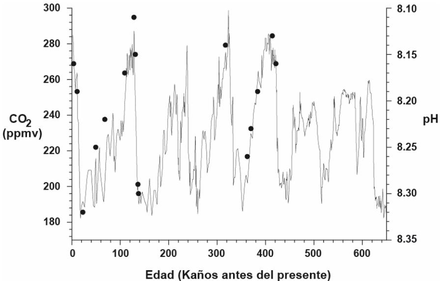
Fig. 3: Registro de pH marino (círculos) reconstruido mediante  $\delta^{11}\text{B}$  en foraminíferos planctónicos de un testigo sedimentario del Océano Atlántico Ecuatorial (HÖNISCH y HEMMING, 2005). La línea continua es la reconstrucción de  $\text{CO}_2$  en base a análisis de testigos de hielo de la Antártida (PETIT *et al.*, 1999; SIEGENTHALER *et al.*, 2005).
