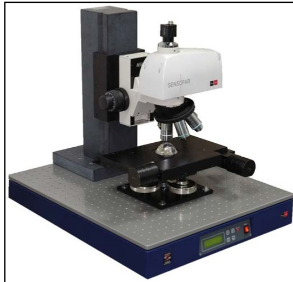
Figura 44. Microscopio confocal SensofarPlu 2300 empleado en la evaluación topográfica de las muestras.
