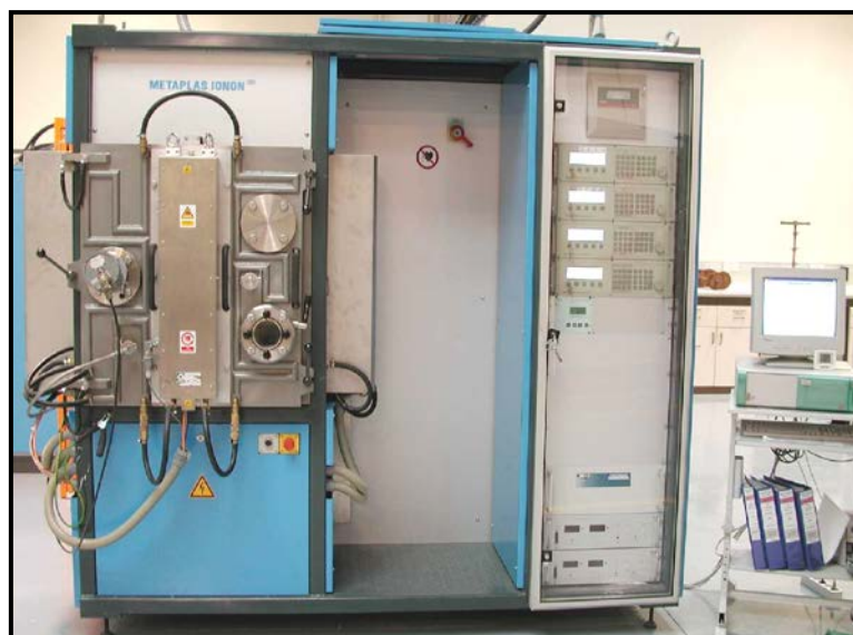
Figura 38. Equipo de PVD por magnetron sputtering , Sulzer-Metaplas-Ionon, modelo MZR 323.
