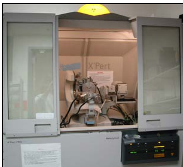
Figura 45. Difractómetro de rayos-X PANalytical PRO-MRD habilitado para la identificación de fases cristalinas
