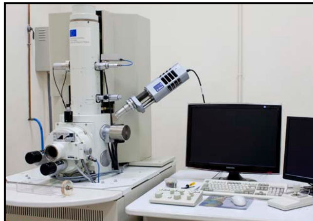
Figura 46. Microscopio electrónico con cañón de electrones de emisión de campo, FEG-SEM en inglés, modelo JEOL JSM 6335F.
