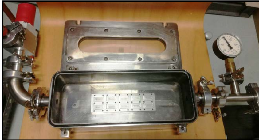
Figura 41. Cámara de control de atmósfera empleada para inertizar el medio gaseoso de ensayo.
