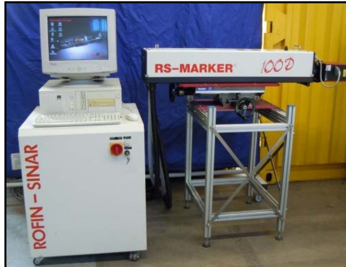
Figura 40. Equipo láser tipo YAG, RS-MARKER 100D ROFIN-SINAIR.
