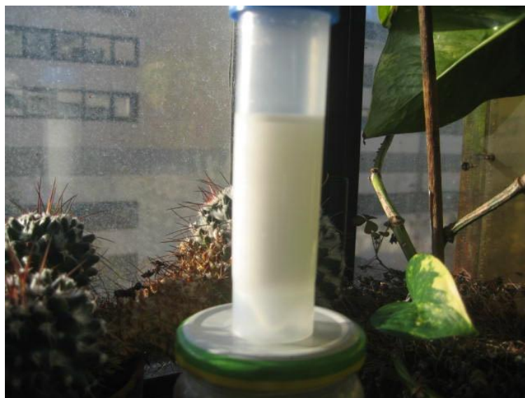
Figura 9 Vista de una mezcla de microencapsulado al 34 %, de densidad 1000 \text{ kg/m}^3
