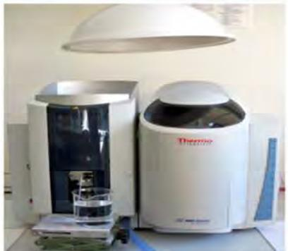
**Espectrofotómetro de Absorción Atómica** con sistema multilámparas de doble longitud de onda
