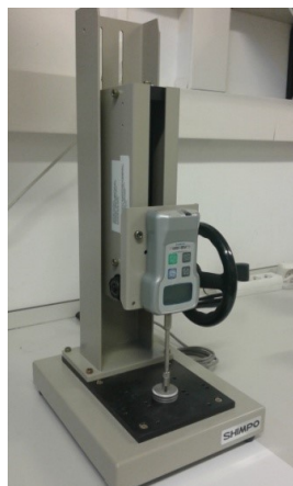
Figura 3.3. Dinamómetro empleado en este trabajo para determinar la resistencia al corte horizontal de los materiales.
