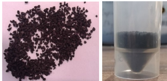
Figura 6.3. Fotografía de pellet P_Cu65Al_COP_a fresco triturado entre tamaños 1 - 2mm.
