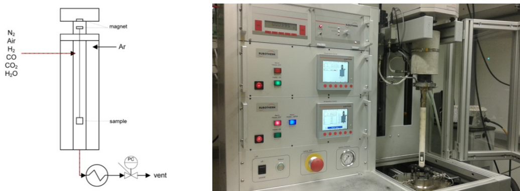
Figura 3.5. Balanza de suspensión magnética de alta presión empleada en estudio de cinéticas de oxidación de materiales de Cu a presión (HPSMB - TuE/Eindhoven).
