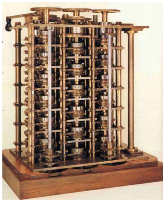
La Máquina Analítica o Máquina de la Diferencia según el prototipo patentado por Charles Babbage.
