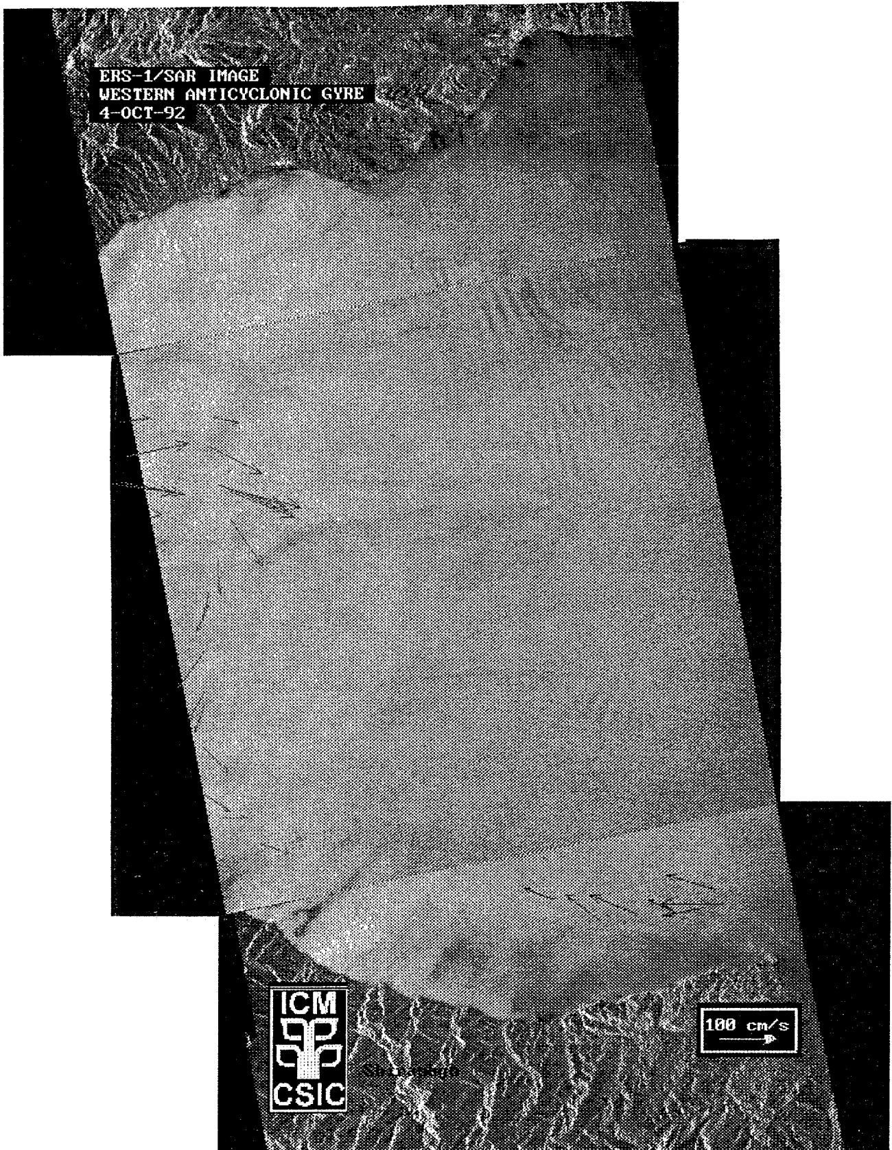
Fig. 4.22 Serie SAR del 4 de octubre con algunos vectores ADCP sobrepuestos, mostrando la entrada de la corriente proveniente del estrecho de Gibraltar (a la izquierda de la imagen) y la parte sur del primer giro GO (parte inferior de la imagen).
