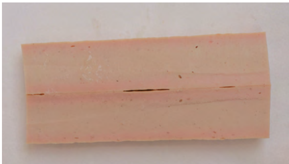
Figura 10. Nitrificación superficial debida a la presencia de pequeñas cantidades de sustancias nitrificantes en el horno de cocción.
