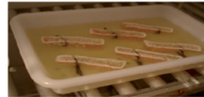
Figura 1. Cilindros inmersos en salmuera
