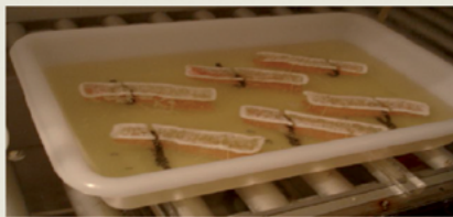
Figura 1. Cilindros inmersos en salmuera
