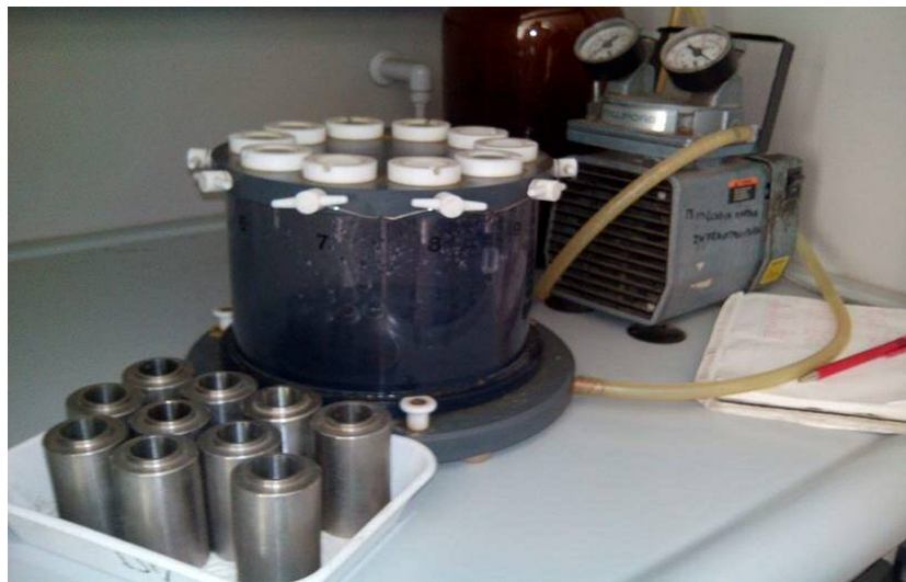
Figura 7. Sistema de filtració.
