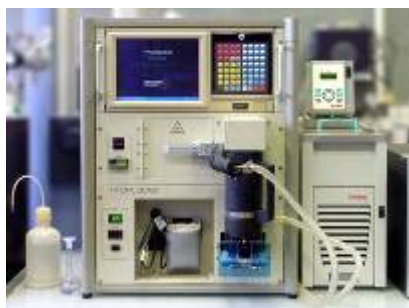
Figura 50. Equipo de adsorción de vapor de agua: Hydrosorb HS-12-HT.
