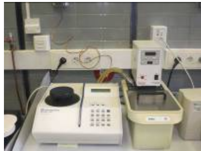
Figura 52. Equipo para la determinación de la densidad real: Micromeritics AccuPyc 1330 Pycnometer.
