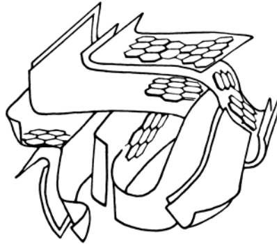
Figura 31. Representación esquemática de la estructura de un carbón activado.
