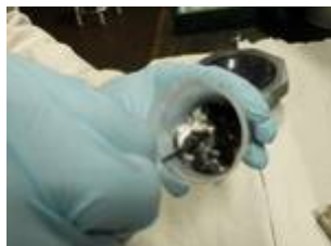
Figura 63. Mezcla física agente activante-precursor carbonoso.
