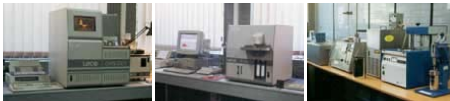
Figura 41. Equipos automáticos para el análisis elemental y poder calorífico: LECO CHN-2000, LECO S-144DR y CALORÍMETROS IKA C4000 y GALLENKAMP.
