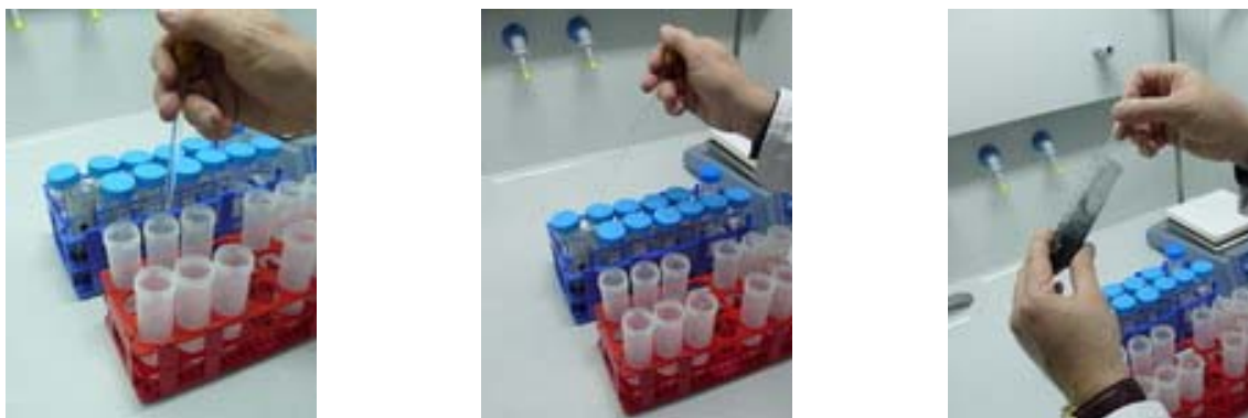
Figura 64. Procedimiento de adición de HCl 5M para el lavado de la muestra.
