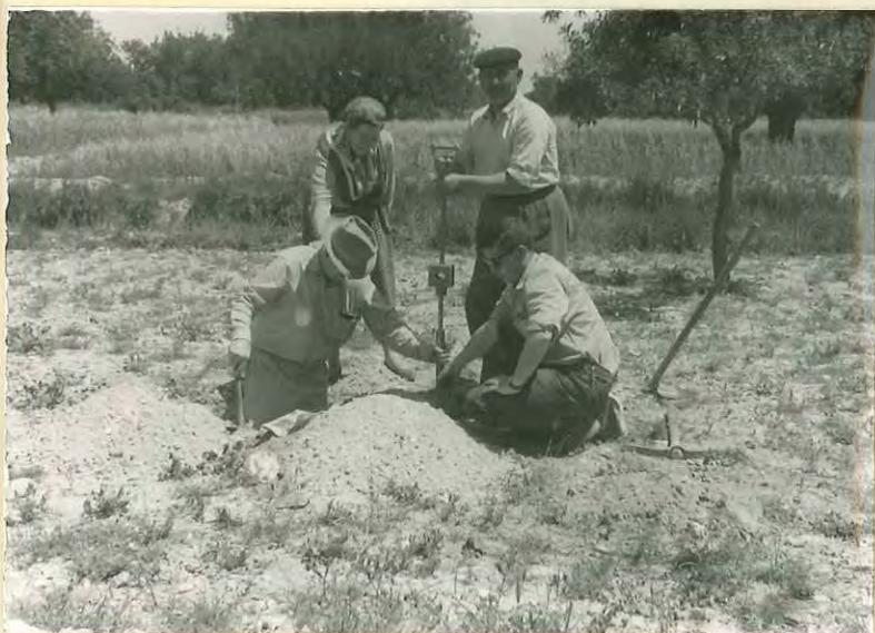
Toma de muestra para determinación de permeabilidad en horizonte hardpan ligeramente cementado.
