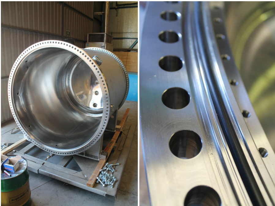
Figure 10.3.2: L'exterior del detector NEXT-100 en les fases finals de la construcció (esquerra). Detall d'una de les juntes que serviran per a mantindre el gas Xenon a pressió sense perdues en el detector (dreta).
