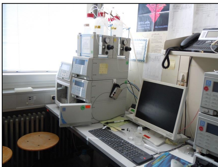
Figura 3.11. Equipo Dionex DX-500 de cromatografía de intercambio aniónico acoplado con un detector amperométrico de pulsos (HPAEC-PAD) del departamento de Biotecnología de Plantas de la Universidad de Stuttgart (Alemania) en el que se realizaron los análisis.
