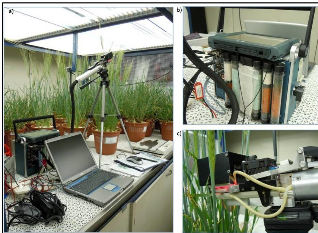
Figura 3.7. Imágenes del analizador de gases en el infrarrojo portátil (CIRAS-2, PP Systems, Amesbury, MA, USA) empleado en la presente investigación para realizar las medidas de la asimilación fotosintética del carbono. a) Imagen del equipo durante la realización de las medidas en la cámara de crecimiento, b) imagen del IRGA, c) cámara foliar que lleva adaptada el IRGA, donde se coloca la hoja para tomar las medidas.
