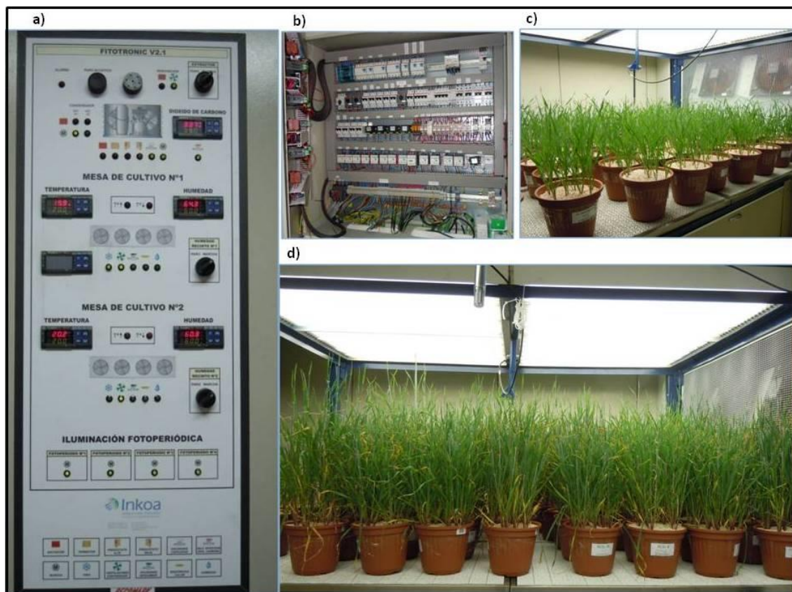
Figura 3.1. Imágenes de la cámara de crecimiento con ambiente controlado (fitotrón, INKOA sistemas S.L): (a-b) panel de control exterior e interior de la cámara, (c-d) mesa sobre la que se colocan las macetas con plantas en diferentes etapas del desarrollo.
